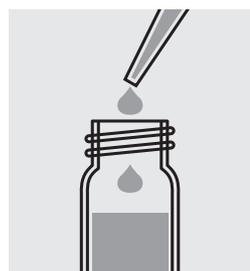
Añadir 2,0 ml **VARIO Sodium hydroxide 1.00 N** con una pipeta, cerrar la cubeta con el tapón roscado y mezclar.
