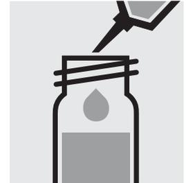
Añadir 3,0 ml de la muestra con la pipeta, cerrar con la tapa roscaada y mezclar. **¡Atención, la cubeta se calienta!**
