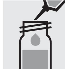
Añadir 0,50 ml de la muestra con la pipeta, cerrar la cubeta con la tapa roscada y mezclar.
