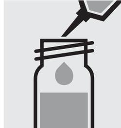
Pipetear 4,0 ml de la muestra en una cubeta de reacción. Cerrar la cubeta con la tapa roscada.
