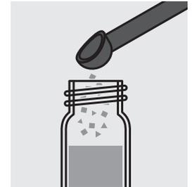
Agregar 1 cuchara micrométrica azul rasa de SO<sub>4</sub>-2 y cerrar la cubeta con el tapón roscado.
