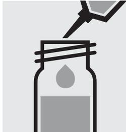
Añadir 2,0 ml de la muestra con la pipeta **cuidadosamente** en una cubeta de reacción, cerrar firmemente con tapa roscada y mezclar intensamente. **¡Atención, la cubeta se calienta!**
