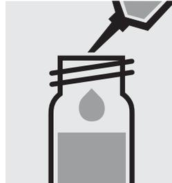
Añadir 5,0 ml de la muestra con la pipeta, cerrar con la tapa roscada y mezclar.
