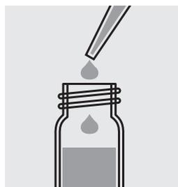
Añadir con una pipeta 2,0 ml de una solución de 1,54 N de hidróxido de sodio, cerrar la cubeta con el tapón roscado y mezclar el contenido invirtiendo la cubeta con cuidado.
