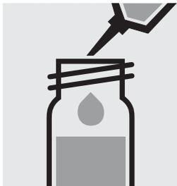
Añadir 5,0 ml de **alcohol isoamílico p. a.** con la pipeta, cerrar con la tapa roscada.
