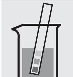
Comprobar el valor del pH de la muestra, intervalo necesario: pH 0–10. En caso necesario, corregir el valor del pH añadiendo gota a gota ácido sulfúrico diluido.
