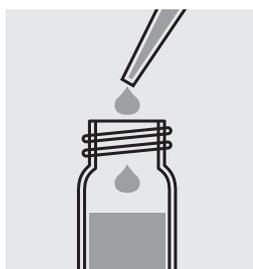
Agregar con la pipeta 2,0 ml de la muestra, cerrar la cubeta con el tapón roscado y mezclar enérgicamente durante 30 s, como mínimo. Puede suceder que una pequeña cantidad de sólido no se disuelva.
