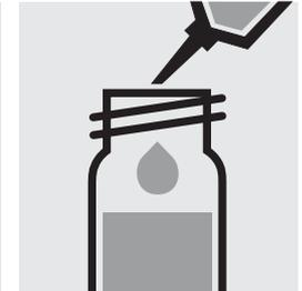
Añadir 2,0 ml de la **mezcla muestra – reactivo** con la pipeta, cerrar la cubeta con la tapa roscada y mezclar.
