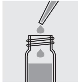
Añadir 0,50 ml de la muestra con la pipeta, cerrar la cubeta con el tapón roscado y mezclar.
