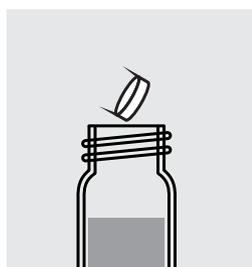
Añadir 1 comprimido de **ALKA-P-PHOTOMETER** directamente de la lámina, aplastar con la barra agitadora y cerrar con la tapa roscada.
