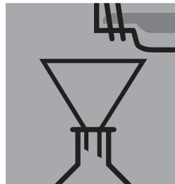
Echar el extracto **al abrigo de la luz** en un matraz aforado (en caso de DIN 38412: 100 ml) haciéndolo pasar por un filtro de papel ("Blau-band"). Relavar el filtro con algo de etanol
