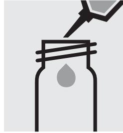
Pipetear 4,0 ml de **AC-1** (de test Capacidad de ácido, art. 252087) en una cubeta redonda.
