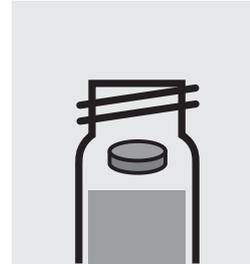
Añadir 1 comprimido de **Cyanuric Acid**, aplastar con la barra agitadora y cerrar con la tapa roscada.
