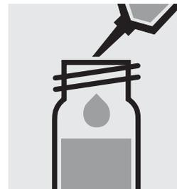
Añadir 1,0 ml de **N-3K** con la pipeta, cerrar con la tapa roscada y mezclar. **¡Atención, la cubeta se calienta!**
