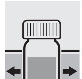
Regular la temperatura del tubo en el baño de agua a 40 °C durante 5 minutos.
