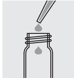
Agregar 0,50 ml de SO<sub>4</sub>-1 en la cubeta vacía con una pipeta.
