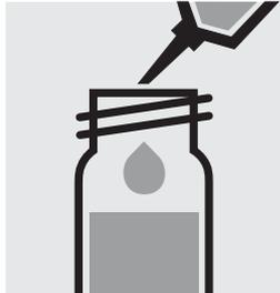
Pipetear 0,50 ml de **Na-1K** en una cubeta de reacción y mezclar.
