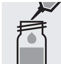
Pipetear 5,0 ml de la muestra en un tubo de ensayo con tapa roscada. **(Importante: no usar tubos de ensayo hechos de vidrio que contenga boro.)**
