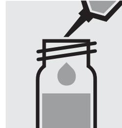
Añadir 5,0 ml de ácido sulfúrico a 40% con la pipeta. Cerrar con la tapa roscada y mezclar.
