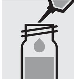
Pipetear 0,50 ml de la muestra en una cubeta de reacción (de test Amonio, art. 250329), cerrar con la tapa roscada y mezclar.
