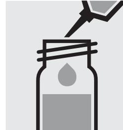
Añadir 1,5 ml de la muestra con la pipeta muy lenta, cerrar con la tapa roscada y mezclar brevemente.
