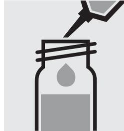
Añadir 5,0 ml de agua destilada con la pipeta en una cubeta, cerrar con la tapa roscada y mezclar.
