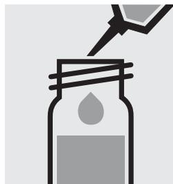
Añadir 5,0 ml de **isobutilmetilcetona p. a.** con la pipeta, cerrar con la tapa rosca.
