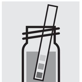
Comprobar el valor del pH de la muestra, valor necesario: pH 6,5. En caso necesario, corregir el valor del pH añadiendo gota a gota solución diluida de hidróxido sódico o de ácido sulfúrico.
