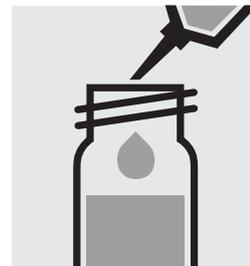
Añadir 1,0 ml de **ácido fosfórico 85% p. a.** con la pipeta. Cerrar con la tapa roscada y mezclar.
