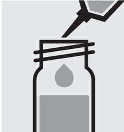
Pipetear 1,0 ml de **NO<sub>3</sub>-1K** en una cubeta de reacción, **no mezclar**.
