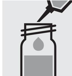
Añadir 0,20 ml de **Cd-1K** con la pipeta, cerrar con la tapa rascada y mezclar.
