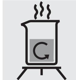
Evaporar casi hasta sequedad 200 ml de la solución de la muestra en un vaso de precipitados sobre la placa calefactora.
