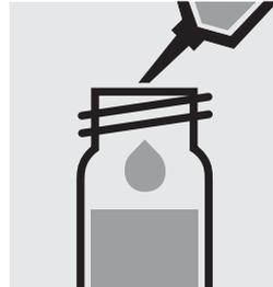
Añadir 1,0 ml de **NO<sub>3</sub>-1K** con la pipeta, cerrar con la tapa roscada y mezclar. **¡Atención, la cubeta se calienta!**
