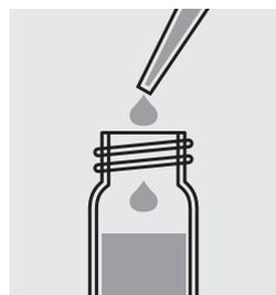
Añadir con una pipeta 2,0 ml de la muestra preparada en una cubeta de reacción **Total Nitrogen Acid HR (Reagent C)** y cerrar la cubeta con la tapa roscada.
