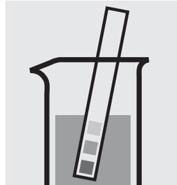
Comprobar el valor del pH de la muestra, intervalo necesario: pH 2–10. En caso necesario, corregir el valor del pH añadiendo gota a gota solución diluida de hidróxido sódico o de ácido clorhídrico.
