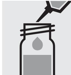
Pipetear 2,5 ml de la muestra en un tubo con tapa roscada.
