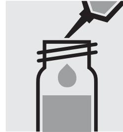
Añadir 10 ml de la muestra con la pipeta, cerrar con la tapa roscada y mezclar.
