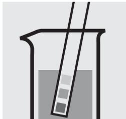
Comprobar el valor del pH de la muestra, intervalo necesario: pH 0–10. En caso necesario, corregir el valor del pH añadiendo gota a gota solución diluida de ácido sulfúrico.
