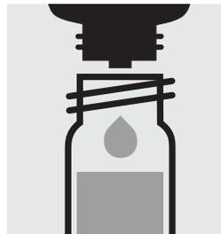
Mezclar el filtrado con 4 gotas de  $\text{SO}_4\text{-4}$  y cerrar con la tapa roscada.
