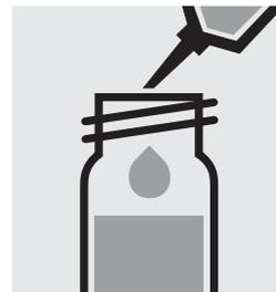
Añadir 1,5 ml de la **muestra preparada** con la pipeta muy lenta, cerrar firmemente con la tapa rosca-da y mezclar brevemente. **¡Atención, la cubeta se calienta!**
