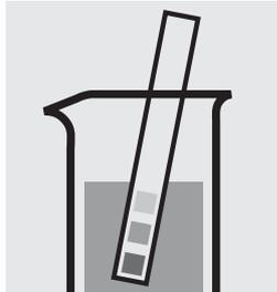
Comprobar el valor del pH de la muestra, intervalo necesario: pH 3–11. En caso necesario, corregir el valor del pH añadiendo gota a gota solución diluida de hidróxido sódico o de ácido sulfúrico.
